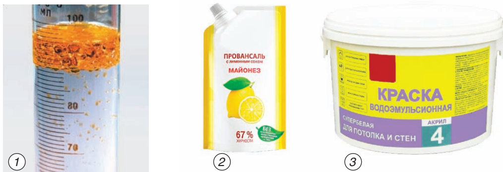
Рис. 93. Эмульсии: 1 — смесь масла с водой, 2 — майонез, 3 — водозэмульсионная краска
