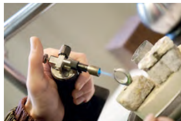
Рис. 66. Сварка ювелирных изделий кислородно-водородным пламенем
