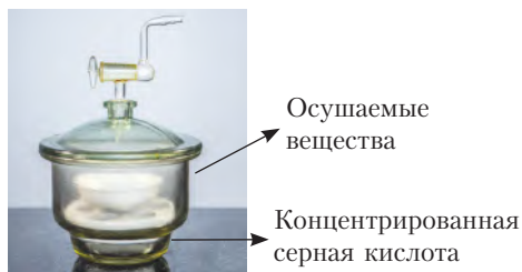
Рис. 86. Эксикатор для хранения и сушки гигроскопичных веществ
