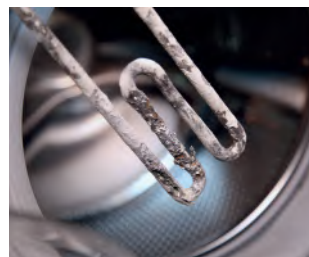
Рис. 112. Накипь на обогревательном элементе стиральной машины
