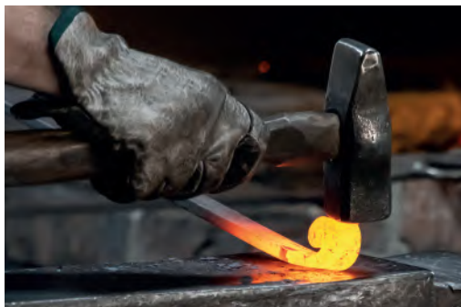
Рис. 104. Ковка металла как демонстрация его пластичности
