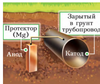
Рис. 116. Защита от коррозии подземного стального трубопровода
